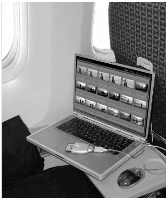
*Рис. 3.3. Устройство считывания с карт памяти представляет собой очень важную принадлежность, позволяющую загружать изображения в компьютер, освобождая от этой функции фотокамеру. При этом экономится также ценная энергия заряда батареи фотокамеры. Подключив такое устройство к портативному компьютеру, можно заняться обработкой полученных изображений даже во время полета на высоте 10 тыс. м*
