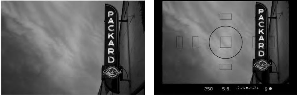
**Рис. 2.21.** В оптический видоискатель цифровой зеркальной фотокамеры видна та же самая сцена и при тех же условиях освещения, что и в объектив во время съемки
