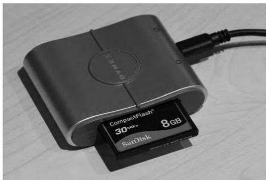
**Рис. 7.11.** Для переноса изображений на компьютер рекомендуется использовать специальное устройство считывания с карт памяти
