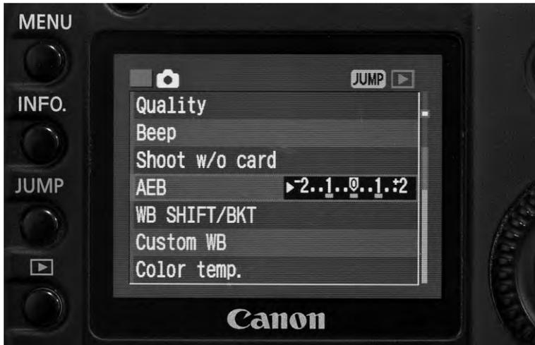
**Рис. 6.23.** Меню выбора и настройки режима автоматической установки экспозиционной вилки в фотокамере Canon 5D. В данном случае фотокамера настроена на съемку трех кадров подряд с экспозицией, отличающейся на одну ступень экспозиционного числа
