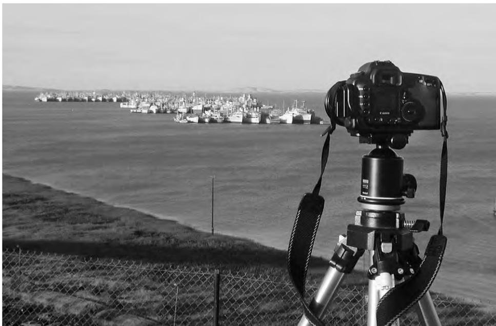
**Рис. 3.6.** Тяжелый штатив просто необходим при съемке в ветреную погоду, как на этом снимке резервной флотилии Суисанского залива вблизи Сан-Франциско. Сильные ветры на такой возвышающейся обзорной площадке нередки, и поэтому предыдущие снимки, сделанные с легкого штатива, получились менее резкими, чем с данного тяжелого штатива
