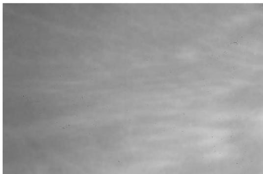
**Рис. 3.43.** Контрольный снимок для проверки наличия пятен от пыли и грязи. Датчику изображения этой фотокамеры требуется основательная чистка!
