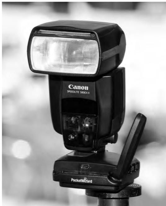
**Рис. 3.16.** Радиосинхронизатор фирмы Pocket Wizard ([www.pocketwizard.ru](http://www.pocketwizard.ru)), установленный на вспышке Canon 580EX II Speedlite
