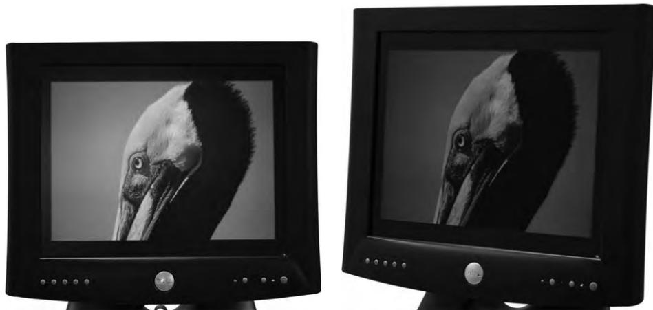
**Рис. 7.6.** Многие ЖК-мониторы обладают ограниченным углом обзора, вследствие чего при просмотре сбоку изображение оказывается темнее
