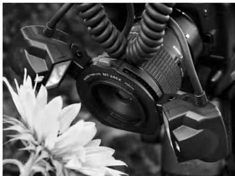
**Рис. 3.19.** Компания Canon выпускает две небольшие головки вспышек модели MT-24EX Macro Twin Lite для тех фотографов, которым требуется максимальный контроль над освещением во время макросъемки. Обе головки присоединяются на конце объектива независимо друг от друга и допускают раздельную регулировку уровня выходной мощности (см. также цветную вклейку)
