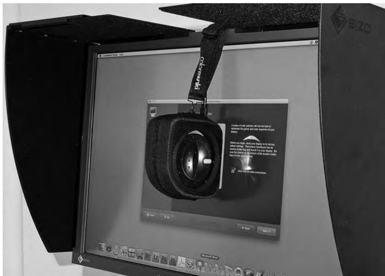
**Рис. 9.4.** Датчик, устанавливаемый на экране монитора, считывает конкретные значения цвета, воспроизводимые профилируемым монитором на этапе его калибровки, обеспечивая формирование как можно более точного профиля
