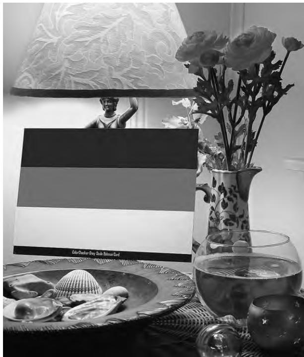
**Рис. 3.47.** Градационная карточка X-Rite Grayscale Card может быть помещена в кадр контрольного изображения и использована, подобно шкале ColorChecker, для установки баланса черного, серого и белого в полученном снимке (см. также цветную вклейку)
