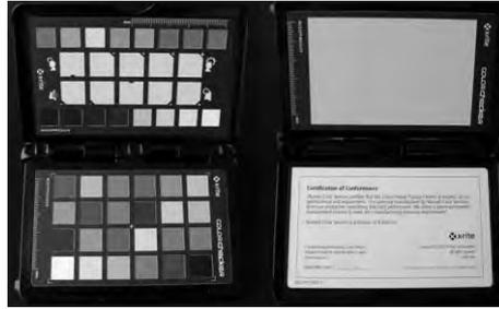
**Рис. 9.1.** X-Rite Color Passport представляет собой компактный набор контрольных шкал, специально предназначенных для цифровой фотографии и профилирования цифровых фотокамер
