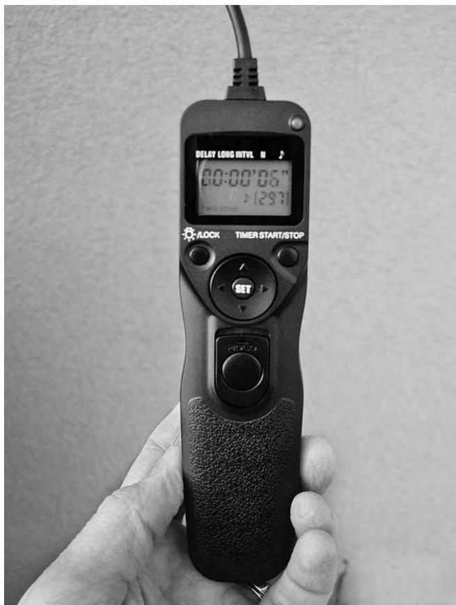
**Рис. 6.53.** В одних моделях цифровых фотокамер имеются встроенные функции интервалометра, а другим требуется внешний интервалометр, подключаемый к ним подобно спусковому тросику
