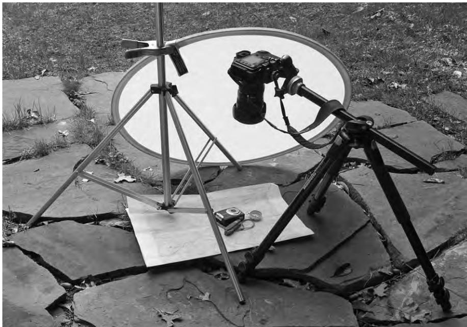
**Рис. 3.23.** *Круглый отражатель MultiDisc, выпускаемый фирмой Photoflex ([www.photoflex.com](http://www.photoflex.com)), сочетает в себе функции одного рассеивателя, показанного на этом рисунке, и четырех тканевых отражателей с разными видами отражающих поверхностей*
