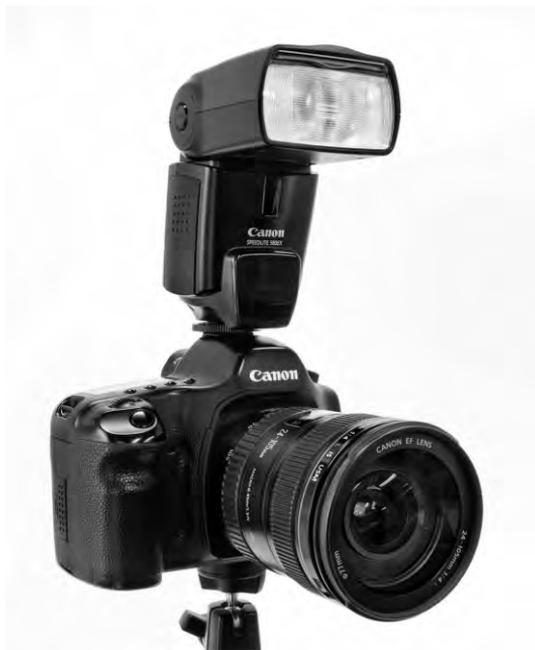
**Рис. 3.11.** Чем выше расположена вспышка, тем ниже залегают тени позади освещаемых ею объектов съемки вместо их оконтуривания. Это также дает возможность видоизменять освещение с помощью специальных отражающих листов, карточек или рассеивателей
