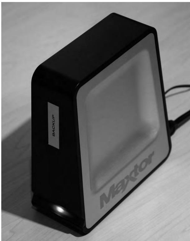
**Рис. 7.8.** Внешний накопитель на жестких дисках — удобный для резервного копирования носитель информации большой емкости
