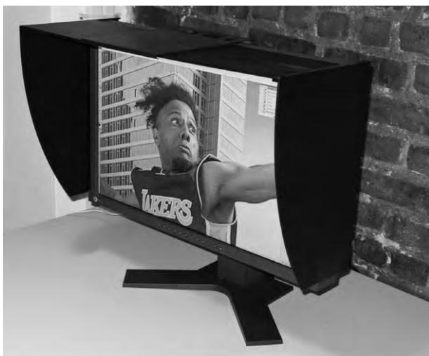
**Рис. 7.2.** Кожух для монитора исключает засветку от общего освещения, мешающую нормальному восприятию изображения на экране монитора
