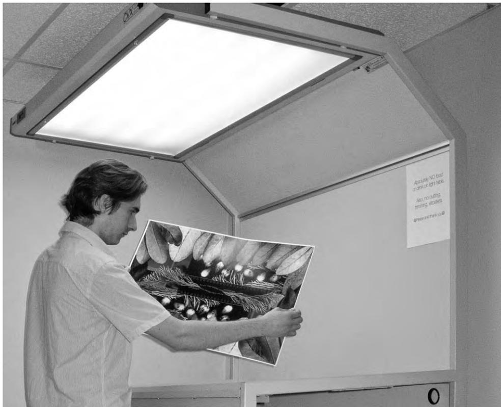
**Рис. 9.6.** Специализированные стенды для просмотра отпечатков, в которых применяются источники света с цветовой температурой 5000 К, отлично подходят для точной оценки отпечатков рядом с монитором. Фото Рейда Элема
