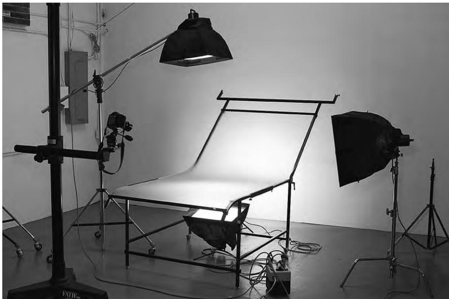
**Рис. 3.55.** Профилированный предметный стол представляет собой студию принадлежность, применяемую для фотографирования разнообразных предметов. Промышленные образцы профилированных предметных столов разных размеров предлагаются фирмами-изготовителями, хотя мастер на все руки может сделать такой стол самостоятельно, закрепив на деревянное раме изогнутый лист матированного оргстекла. Фото Марка Бекельмана и Джона Парсекиана
