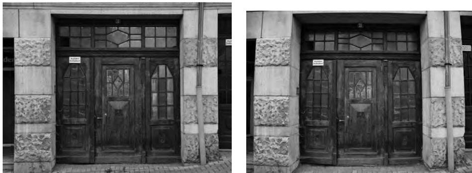
**Рис. 2.15.** Бочкообразное искажение делает изображение “выпуклым”, что наиболее заметно на прямых линиях вблизи краев изображения, где они изгибаются наружу. Слева показан снимок, сделанный при установленном фокусном расстоянии 24 мм. На нем хорошо заметно бочкообразное искажение. А справа показан снимок, сделанный при установленном фокусном расстоянии 60 мм. При таком фокусном расстоянии объектива бочкообразное искажение, как правило, не возникает
