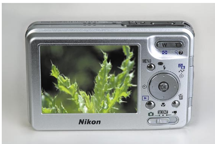
Рис. 2.2. Основными элементами на задней панели фотоаппарата являются ЖК-видоискатель и ряд кнопок управления
