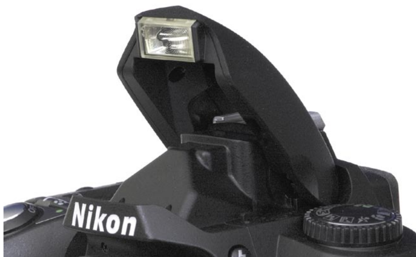
Рис. 2.8. Чем выше и дальше от объектива находится вспышка, тем менее вероятно возникновение эффекта «красных глаз»
