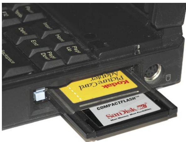
Рис. 2.16. Ноутбук, оборудованный разъемом PC Card и адаптером, может служить «домом» для ваших цифровых снимков вдали от дома
