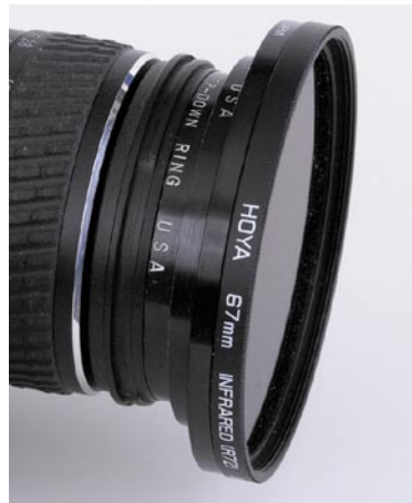
Рис. 2.18. Кольца-адаптеры позволяют получить двойную выгоду от фильтров и других дополнений к объективу
