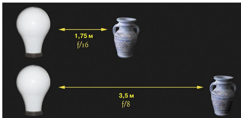
Рис. 6.13. Если источник света расположить вдвое дальше от объекта съемки, то создаваемое им эффективное освещение уменьшится в четыре раза (два f -числа)
