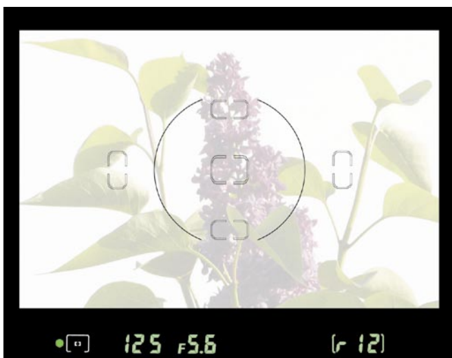
Рис. 3.17. Для вычисления корректного фокуса могут использоваться пять или более «целевых» областей
