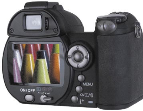
Рис. 10.1. Эта камера оснащена ЖК-экраном, расположенным на задней панели, и внутренним электронным видоискателем, что делает ее идеально подходящей для макросъемки
