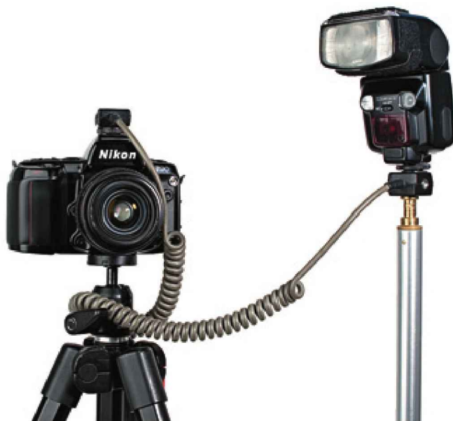
Соединение вспышки с камерой многоконтактным синхрокабелем. Все режимы и функции сохраняются. Удобно для создания бокового света
