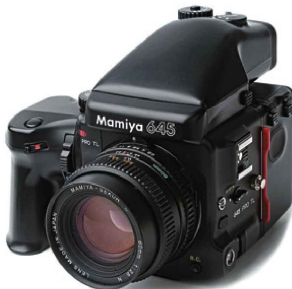
Среднеформатная (6×4,5) электронная камера с петлепризмой и сменными кассетами для плёнки
