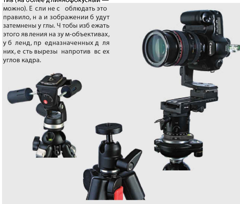
Три типа штативных головок. Первый вариант с тремя рукоятками удобен при съёмке интерьера или репродукций. Но такая головка более тяжёлая. Шаровая головка легче и прекрасно подходит для большинства типов съёмки. Панорамная головка позволяет вращать камеру относительно нодальной точки — точки пересечения лучей в объективе
