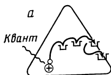
Рис. 10. Стадии образования единичных атомов фотолитического серебра и брома при зарождении скрытого изображения
