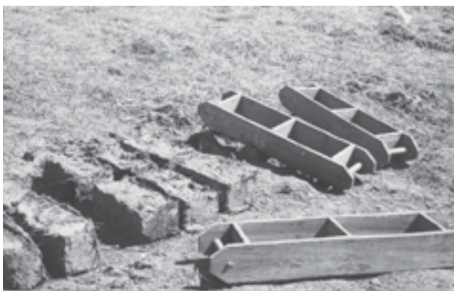
Станки из досок для формования кирпичей из глино-соломенных смесей
