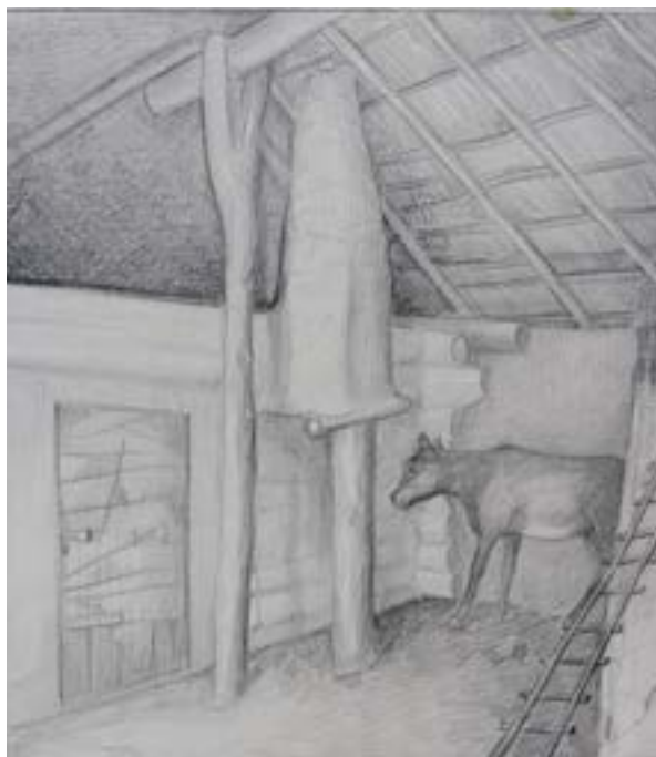
Старинные варианты дымовых труб при «полубельях» печах с выходом дыма в сени: плетеная труба, обмазанная глиной. Дом построен в первой половине XIX в. Д. Дурново Крупецкого района Курской обл.
