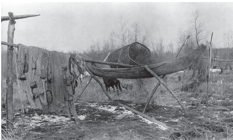
Илл. 25. Для разведения бортов лодки под ней устраивают костер; в данном случае на козлах установлен уже готовый обласок. Фото: К. Доннер, 1912 г.
