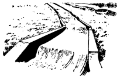
Рис. 57. Лестница-рыбоход на реке Тулома
