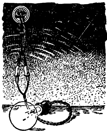
Рис. 34. Проверка соединительного шнура на обрыв.
