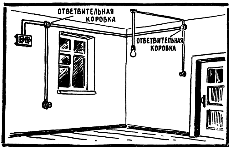
Проводка проводом ППВ в комнате.
