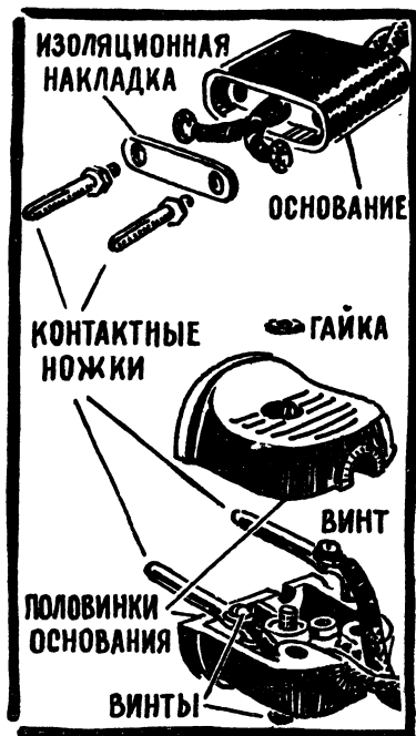
Подключение проводов к штепсельным вилкам.
