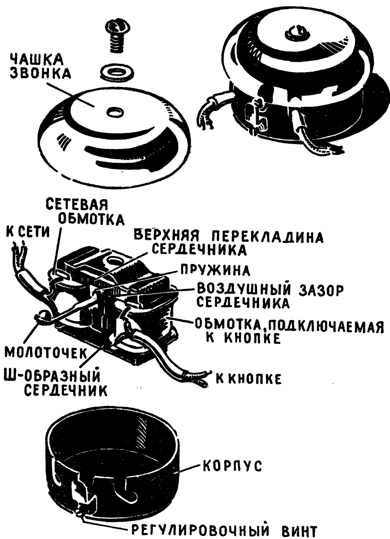
Звонок и его детали.
