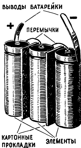
Устройство батарейки карманного фонаря.
