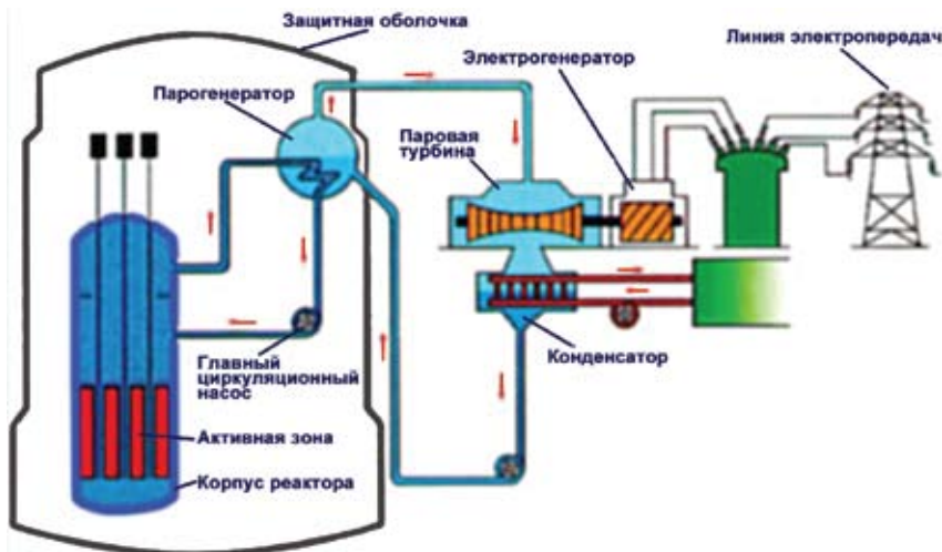
Схема установки с реактором типа ВВЭР
