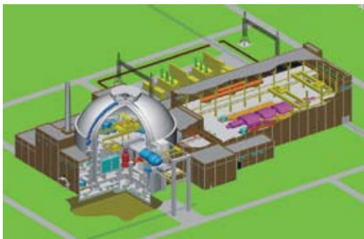
Внешний вид энергоблока с реактором ВВЭР-1200
