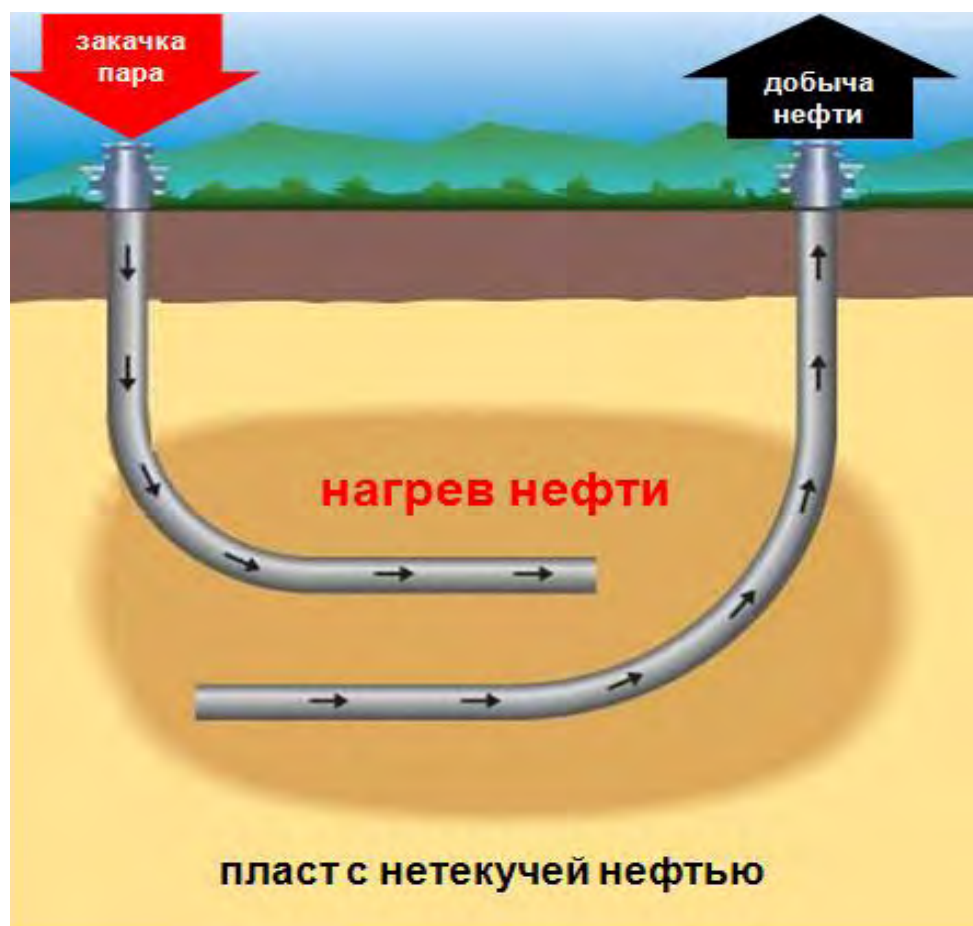
Рис. 16.9. Схема строительства встречных горизонтальных скважин для добычи тяжелой нефти из битуминозных песков
