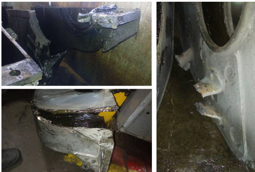
Рисунок 8 – Основные изломы кожуха зубчатой передачи электровозов серии 2(3)ЭС5К
