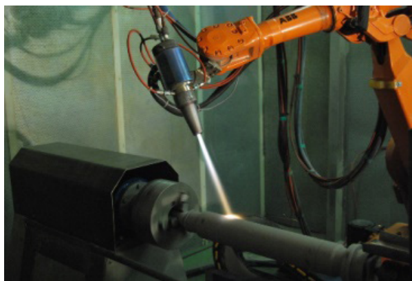
Рисунок 1. Высокоскоростное (сверхзвуковое) газопламенное напыление медью
