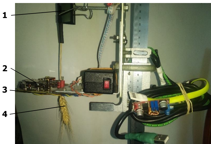
1 – зажим; 2 – вибрационное устройство; 3 – подставка; 4 – стебель с колосом Рисунок 1 – Экспериментальная установка для изучения вибрационного воздействия на стебель с колосом
