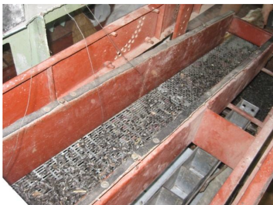
Рисунок 5 - Ярус решёт на стенде
