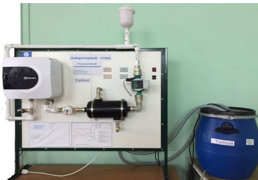
Рисунок 1 - Лабораторная установка «Кожухотрубный теплообменник»
