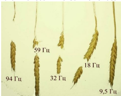
а б Рисунок 2 – Результаты воздействия на колос пшеницы колебаний (а) с частотами, совпадающими с его собственными резонансными частотами (б)
