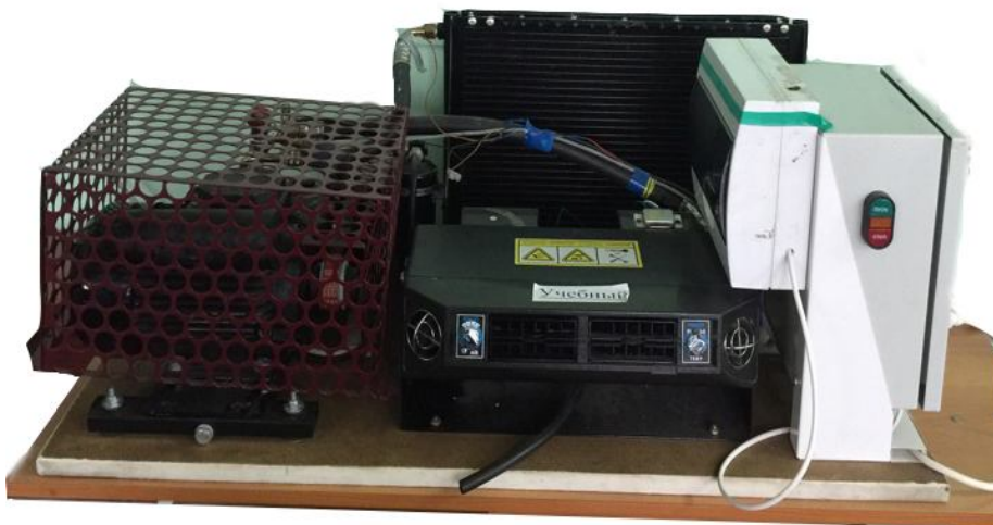
Рисунок 2 - Лабораторно-диагностический стенд «Автомобильный кондиционер»
