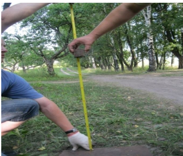
Рисунок 1 - К определению высота падения, при которой почвенный образец при ударе о металлическую поверхность разрушается
