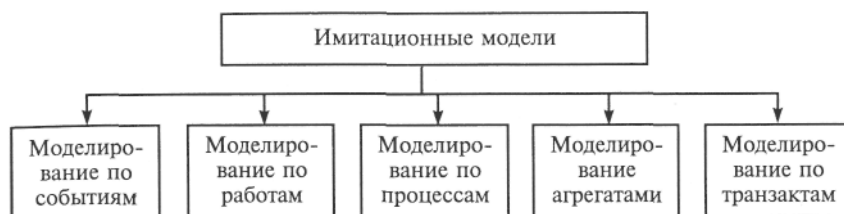
Рис. 9.4. Классификация имитационных моделей по способу организации квазипараллелизма
