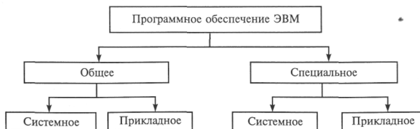
Рис. 1.2. Структура программного обеспечения ЭВМ (АИС)
