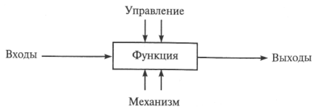
Рис. 4.1. Функциональный блок и интерфейсные дуги
