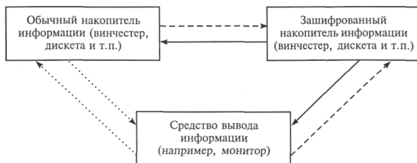
Рис. 3.2. Общая схема прозрачной дисковой защиты:
