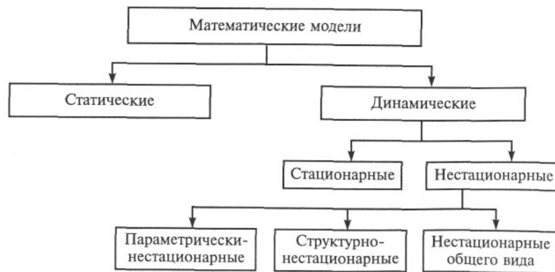
Рис. 8.4. Классификация математических моделей по зависимости переменных и параметров от времени
