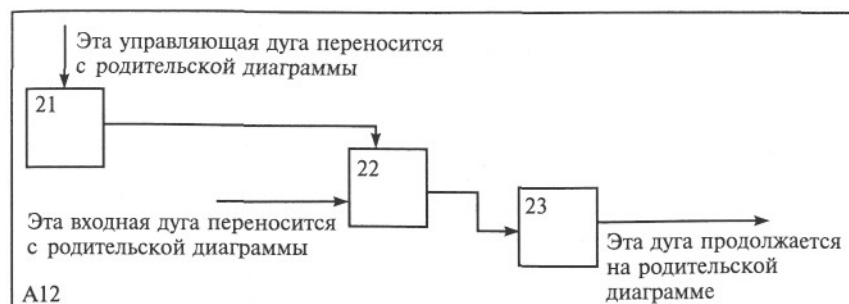
Рис. 4.2. Структура SADT-модели (декомпозиция диаграмм): a — общее представление; б — детальное представление
