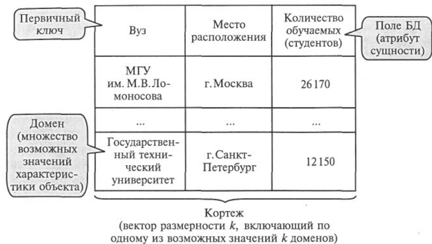
Рис. 5.11. Реляционная модель данных
