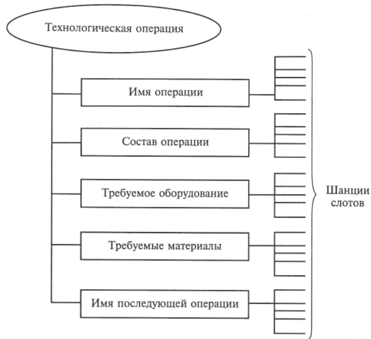
Рис. 13.3. Фрейм понятия «технологическая операция»
