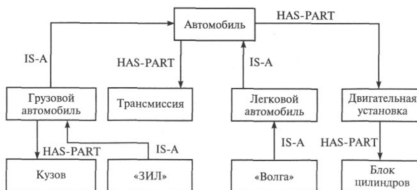
Рис. 13.5. Фрагмент семантической сети понятия «автомобиль»:
