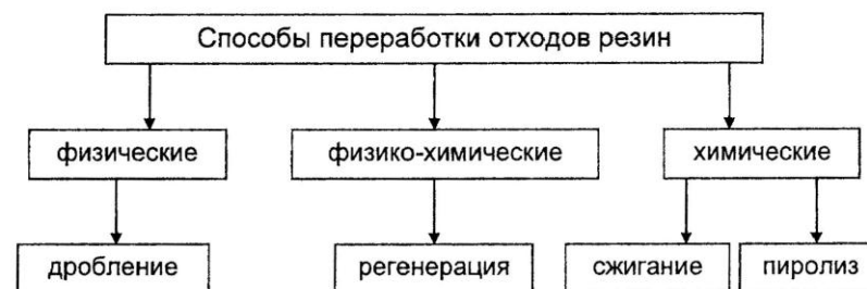
Рис. 9.1. Классификация способов утилизации отходов резин
