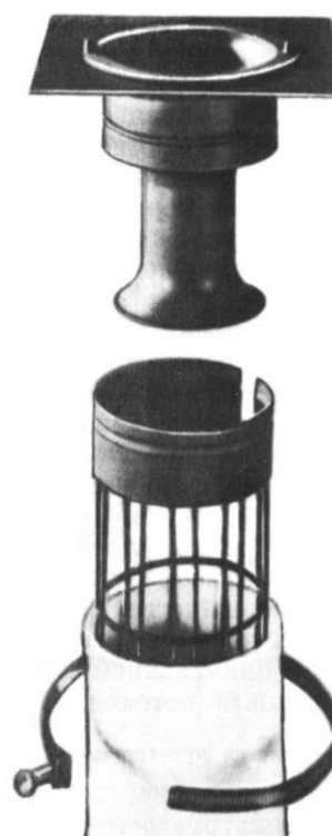
Рис. 1.28. Рукав в сочетании со скруббером Вентури
