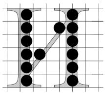
Рисунок 6.4 Пример выпадения точек при заполнении контура
