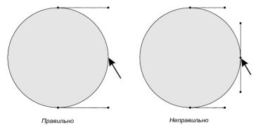
Рисунок 9.2 Отсутствие выделенных точек экстремумов в округлых элементах
