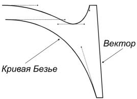
Рисунок 6.9 Образец контура символа в формате Туре 1
