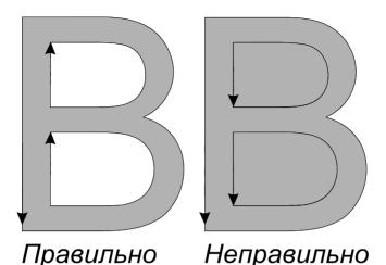
Рисунок 6.10 Правило заполнения контуров в формате Туре 1
