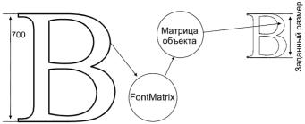
Рисунок 6.8 Схема преобразования символа
