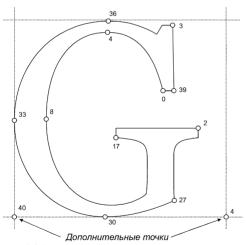
Рисунок 6.21 Дополнительные точки, определяющие поля символа в TrueType-шрифтах
