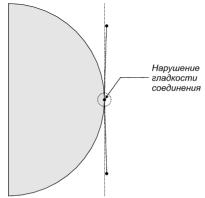
Рисунок 9.1 Нарушение гладкости соединения графических примитивов
