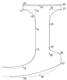
Рисунок 6.20 Нумерация точек, определяющих контур в TrueTypeшрифтах
