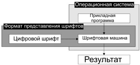
Рисунок 6.1 Схема реализации шрифтовой машины
