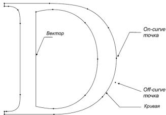
Рисунок 6.15 Построение контуров в TrueType-шрифтах
