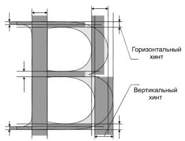
Рисунок 6.13 Хинты локальной разметки формата Туре1
