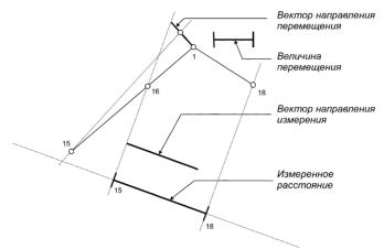
Рисунок 6.22 Принцип измерения расстояний между точками в TrueType-шрифтах
