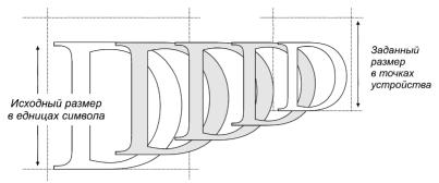
Рисунок 6.18 Схема процесса масштабирования для TrueType-шрифтов
