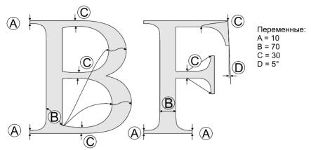
Рисунок 6.7 Элементы разметки при программируемом методе
