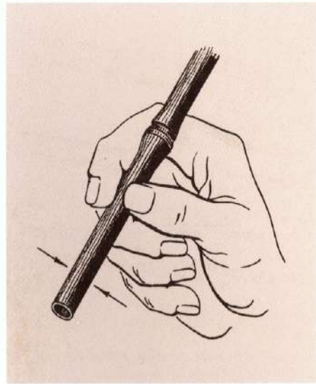
Рис. 35. Определение жесткости камышовой палочки.
