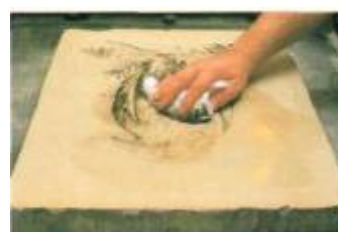
3. По истечении этого времени промойте камень уайт-спиритом, чтобы удалить остатки жировых веществ.
