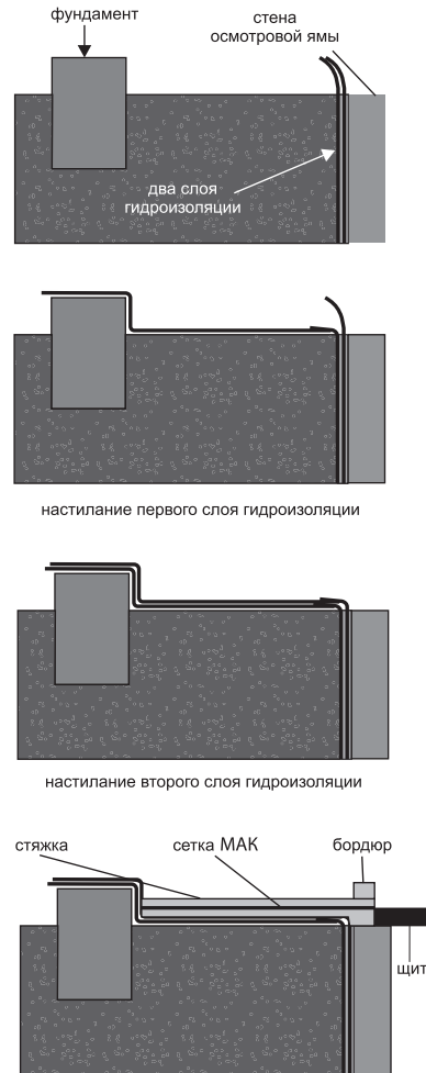
Рис. 13.6. Устройство стяжки
