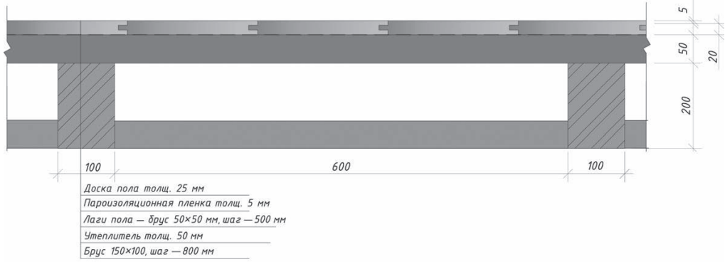
Рис. 5.3. Конструкция перекрытия по несущим балкам
