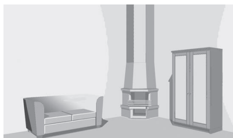
Рис. 10.14. Угловой камин с пристроенным дымоходом
