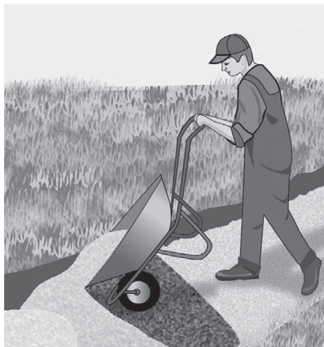
Рис. 3.7. Доставка песка для устройства песчаной подушки
