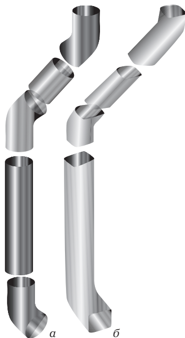
Рис. 5.30. Сечения водосточных труб: а — круглое; б — квадратное
