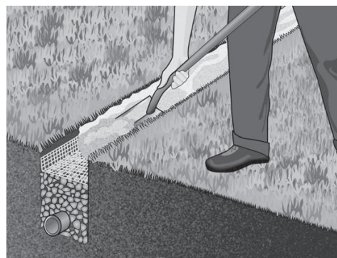
Рис. 2.7. Засыпка дренажа
