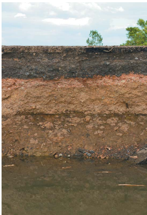
Рис. 2. Крупнообломочный грунт
