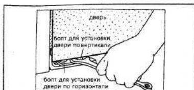
Рис. 32. Регулировка положения двери
