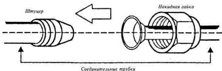
Рис. 9. Стыковка медных соединительных трубок
