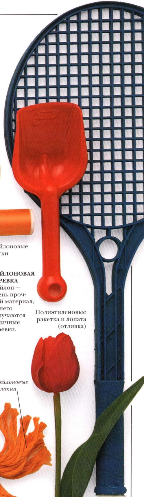
Полиэтиленовые ракетка и лопата (отливка)
