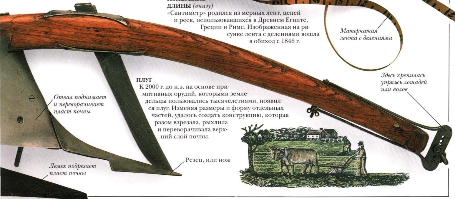
Отвал поднимает и переворачивает пласт почвы
