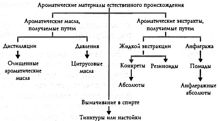
Схема различных способов получения ароматических материалов
