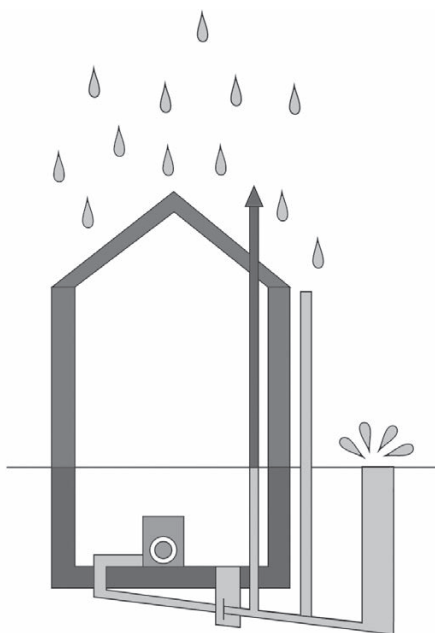
Рис. 8.16 Защита от обратного подпора помогает избежать затопления даже во время сильных дождей
