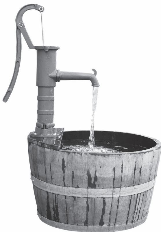
Рис. 3.9. Абиссинский колодец
