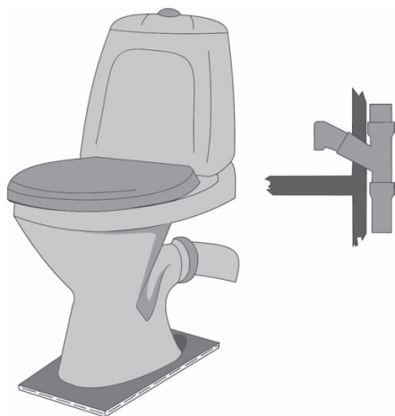
Рис. 7.13. Крепление унитаза к деревянной панели
