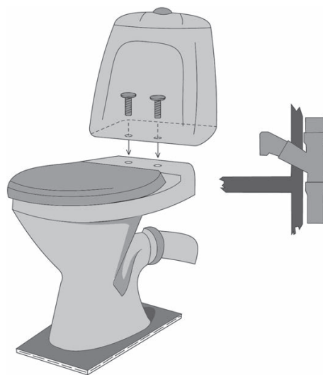
Рис. 7.15. Подсоединение бачка к полке унитаза
