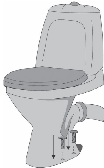
Рис. 7.12. Крепление унитаза на шурупы
