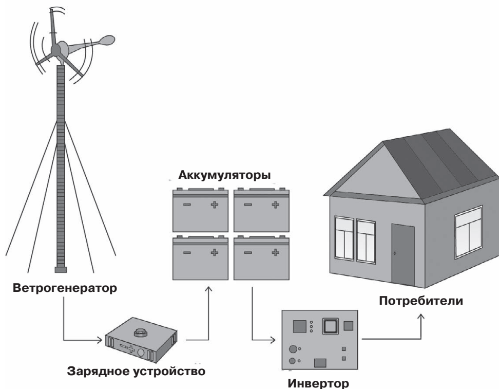
Рис. 2.3. Схема ветроэлектростанции
