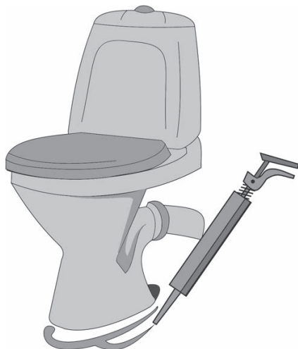
Рис. 7.14. Крепление унитаза на клей
