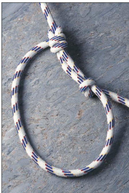
Булинь, укрепленный простым узлом
