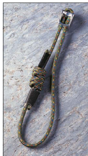
Петля альпинистской закладки укрепляется и становится более надежной за счет использования двойного рыбацкого узла и обмотки концов
