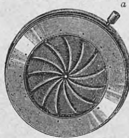
Рис. 5. Диафрагма-присъ съ круглыми отверстіями. а — винтовая головка, вращеніемъ которой по желанію измѣняютъ радиусъ отверстія.
