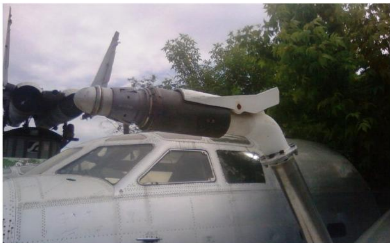
3.16. Приёмное устройство дозаправки топливом в воздухе фронтового бомбардировщика Су-24 (Пермский музей авиации)
