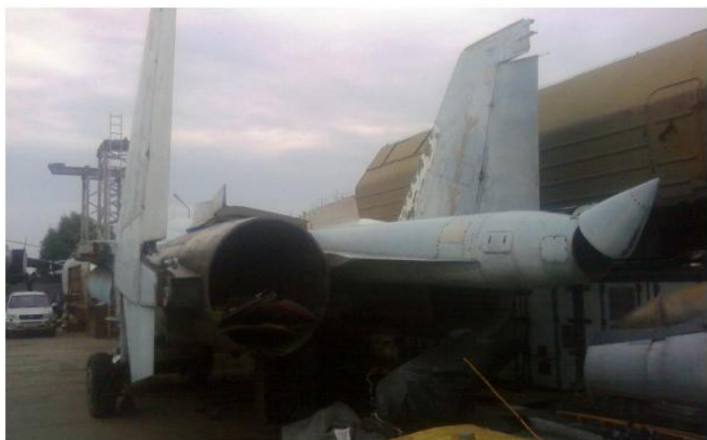
3.17. Фюзеляж истребителя Су-27. Вид с хвоста слева. Консоли крыла и горизонтальное оперение сняты. Крышка отсека тормозных парашютов приоткрыта (Пермский музей авиации)
