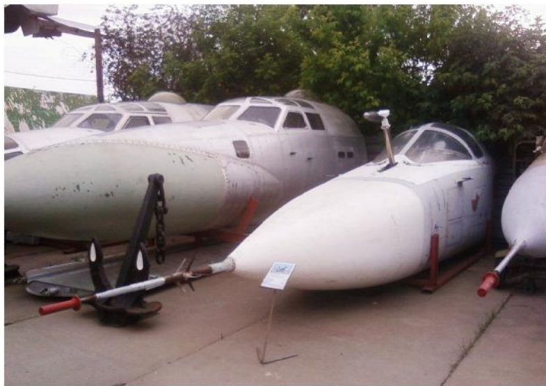
3.16. Носовая часть фронтового бомбардировщика Су-24 с поднятой штангой дозаправки в воздухе – экспонат Пермского музея авиации
