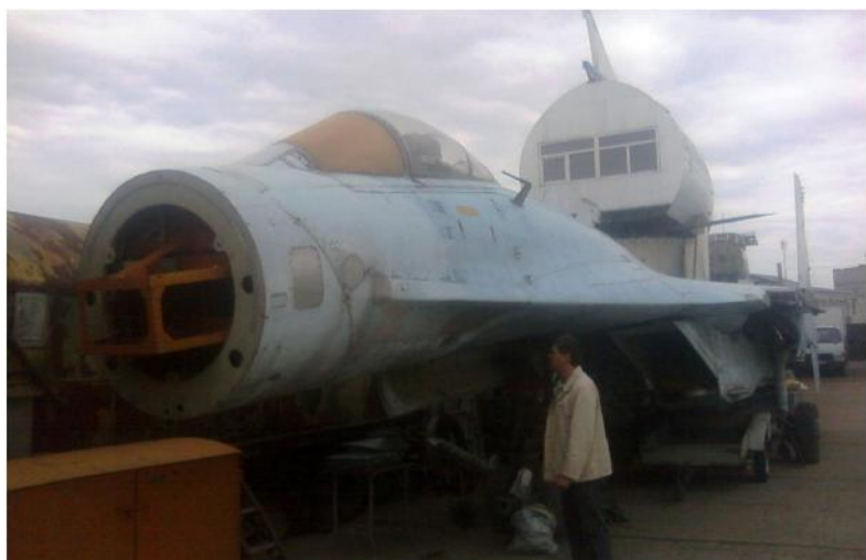
3.17. Фюзеляж истребителя Су-27. Вид спереди слева. РЛС, носовой обтекатель и консоли крыла сняты (Пермский музей авиации)
