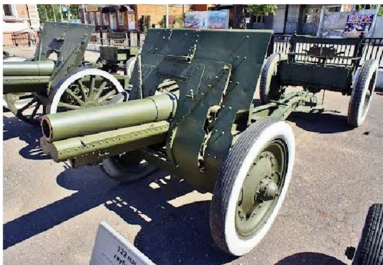
6.5.2. 122-мм гаубица образца 1910/30 гг. с орудийным передком 52-Р-460 (на металлических колёсах)
