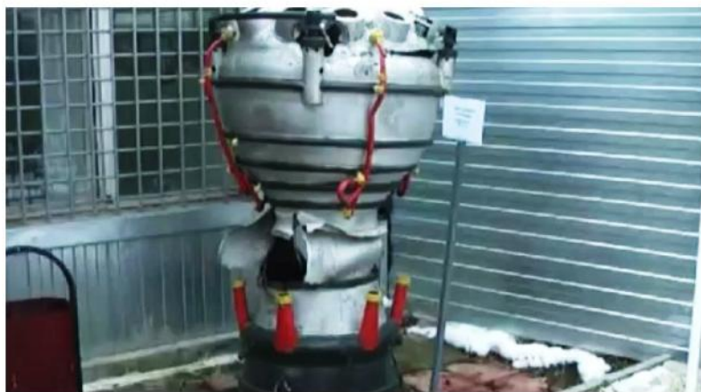
5.9. Жидкостный ракетный двигатель РД-100 баллистической ракеты Р-1 (музей 52-й ракетной дивизии РВСН, ЗАТО «Звёздный»)
