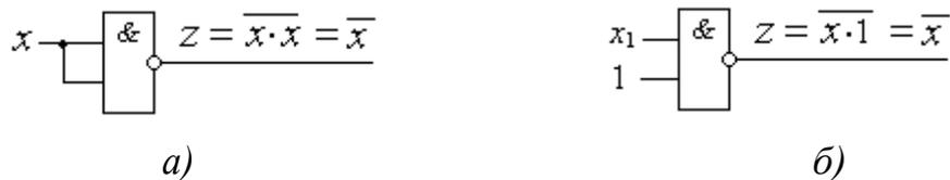
Рис. 3.7. Способы использования элемента типа И-НЕ в качестве инвертора
