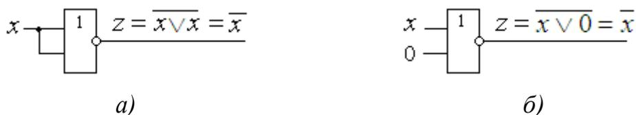
Рис. 3.9. Способы использования элемента типа 2ИЛИ-НЕ в качестве инвертора
