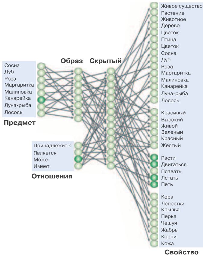
Рис. 3.40. Нейросети способны обрабатывать символическую информацию. Эта нейросеть представляет набор простых утверждений, таких как «Малиновка — это птица» или «У розы есть лепестки». (Источник: McClelland and Rogers, 2003.)
