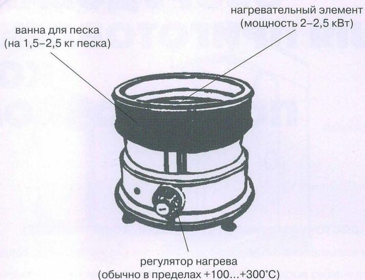
В качестве теплоносителя в АПВ обычно используется мелкий кварцевый песок, потому что он может обеспечить равномерный и сильный нагрев.
