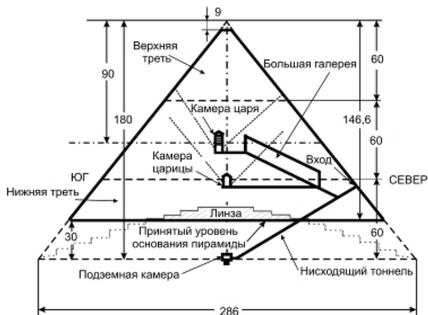
Рис. 108. Разрез Великой Пирамиды, если принять за нулевой уровень пол Подземной камеры
