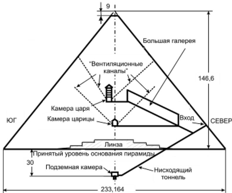
Рис. 107. Схематический разрез Великой Пирамиды в направлении север-юг (размеры указаны в метрах)
