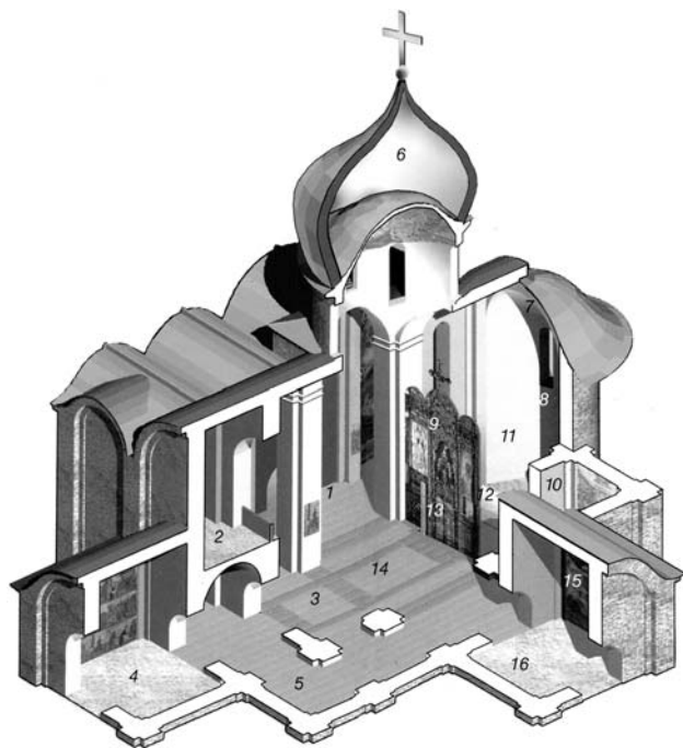
Крестово-купольный храм. Аксонометрический разрез.
