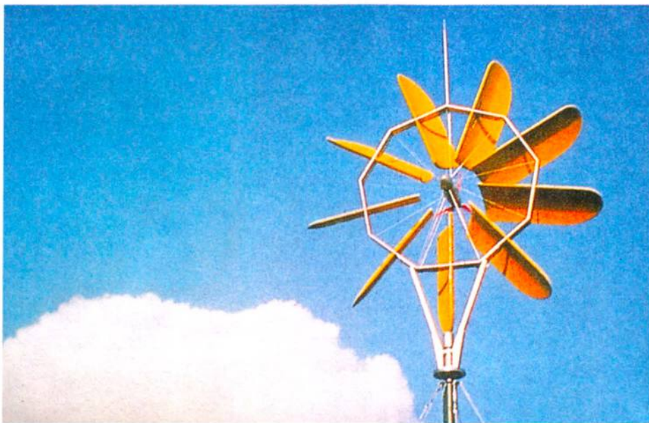
Благодаря твердому венку несущих крыльев маленькая турбина очень быстро вращается.
