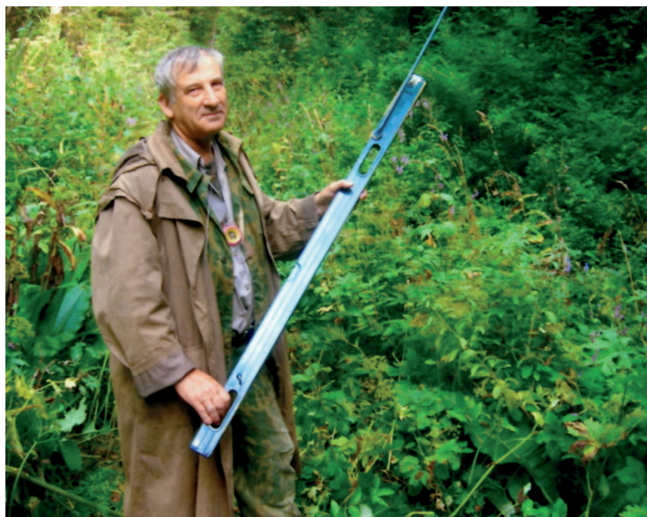
Щуп для проверки в сыпучих грунтах (заболоченных местах) в рабочем по- ложении и как заземлитель в период временной вариации
