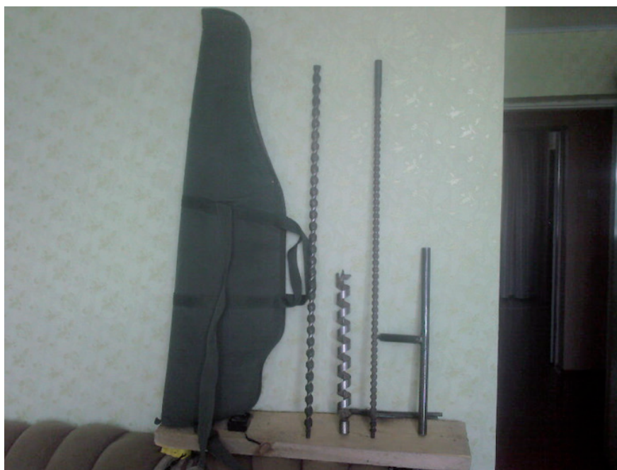
Бур диаметром 35,0 мм с победитовым наконечником в разобранном виде и чехол для переноски (фото автора, 2016 год)
