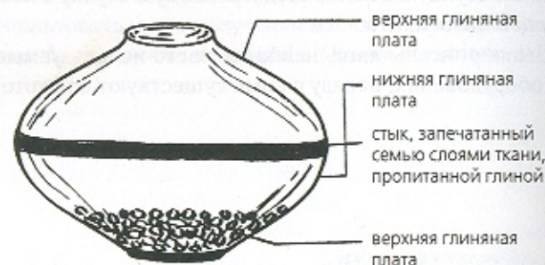
Рис. 22. ŚARĀVA SAMPUTA (КОНТЕЙНЕР ИЗ ДВУХ ГЛИНЯНЫХ ТАРЕЛОК)
