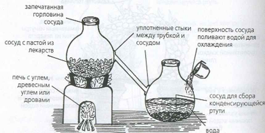
Рис. 12. TIRYAK PĀTANA YANTRA (АППАРАТ ДЛЯ ПЕРЕГОНКИ)
