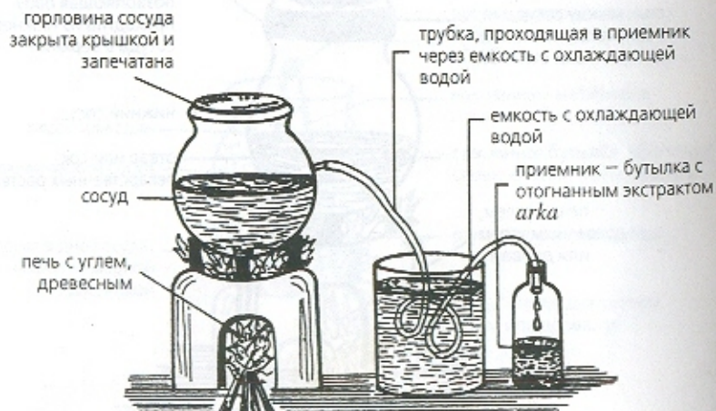
Рис. 18. NĀDIKĀ YANTRA (АППАРАТ ДЛЯ ЭКСТРАКЦИИ АРКА)
