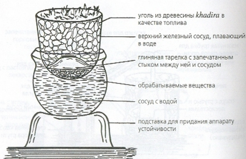
Рис. 14. КАССАПА ЯНТРА (ЧЕРЕПАХА, ИЛИ ПЛАВАЮЩИЙ АППАРАТ)
