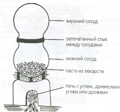
Рис. 19. ḌAMARU YANTRA (АППАРАТ В ФОРМЕ ГАНТЕЛИ)
