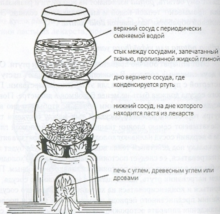
Рис. 11. ŪRDHVA PĀTANA YANTRA (АППАРАТ ДЛЯ ВОЗГОНКИ)
