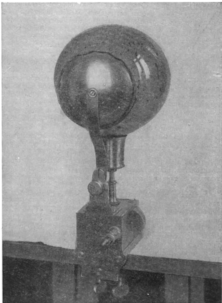
Шаровая электрическая машина, изготовленная в мастерских Академии наук в 1772 г.
