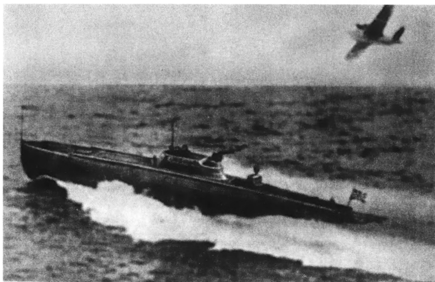
Торпедный катер «Первенец» (Ш-4) конструкции А.Н. Туполева на испытаниях
