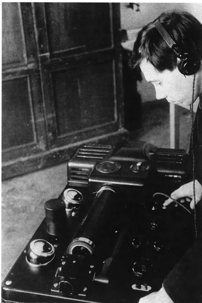
Старший техник ЦЛПС А. Сейко принимает телеграмму на фототелеграфном аппарате ФТ-35
