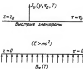
Рис. 4.1. К задаче о переносе излучения через среду быстрых электронов (одномерная задача). Облако спереди звезды
