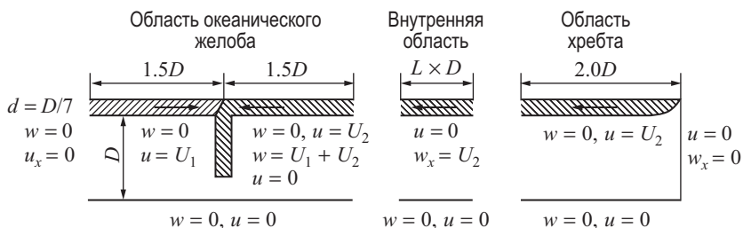
Рис. 70. Идеализированная двухслойная модель тектоники плит. Показана литосфера, перекрывающая верхнюю мантию, которая предполагается ньютоновской жидкостью. Модель состоит из трех зон, которые состыковываются с помощью граничных условий в полную модель с горизонтальной протяженностью L , зависящей от выбора размеров внутренней области (т.е. практически — от размеров плиты). Граничные условия выражаются через горизонтальную u и вертикальную w компоненты скорости, а индекс “ x ” или “ z ” указывает на частную производную по соответствующей переменной (например, w_x = \partial w / \partial x )
