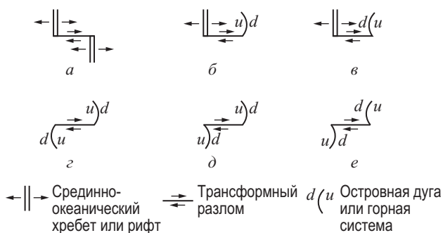
Рис. 57. Диаграмма, иллюстрирующая шесть возможных типов правосторонних трансформных разломов (по Уилсону, 1965)
