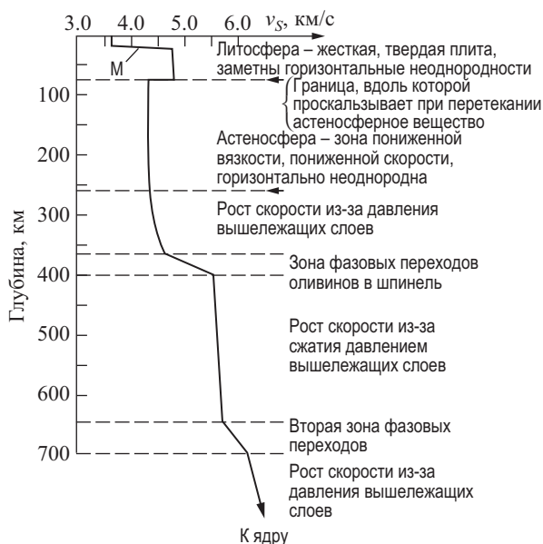
Рис. 35. Одна из первых современных реальных моделей мантии Земли. Модель построена по данным сейсмологии и результатам лабораторных исследований при высоких давлениях
