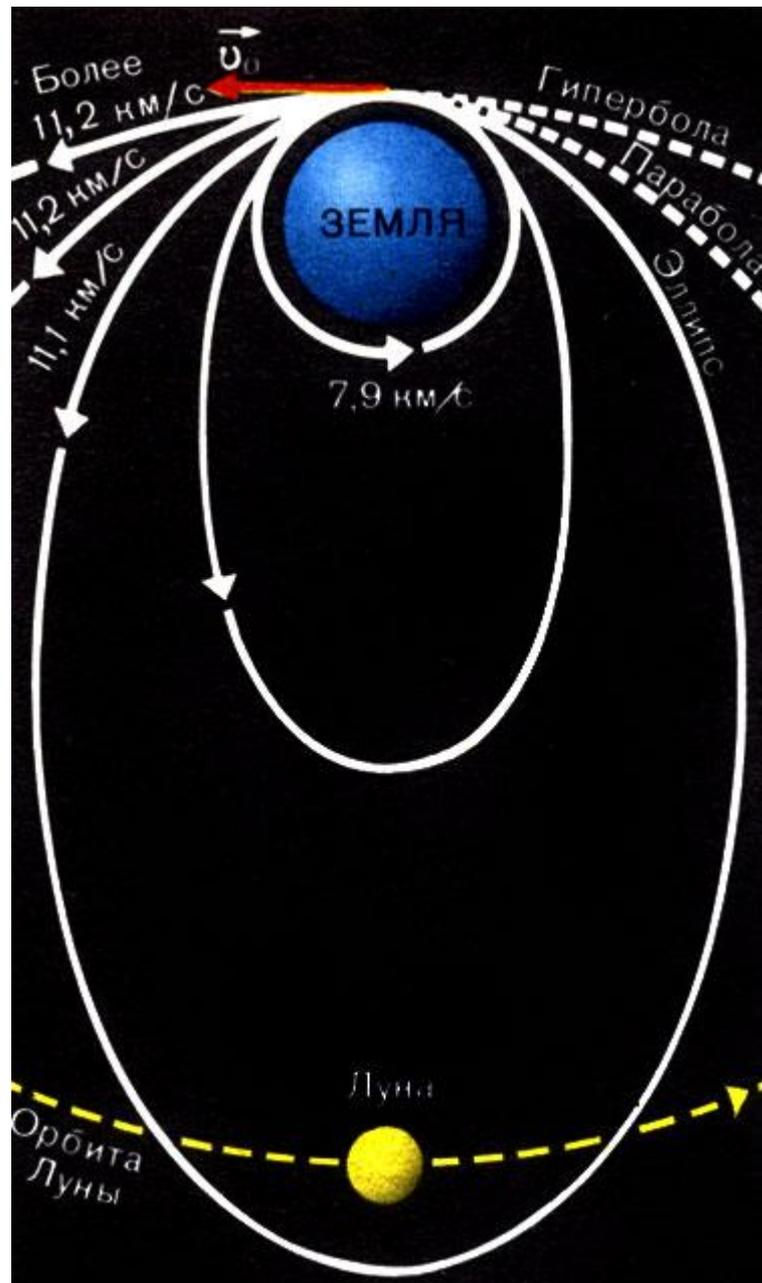
**Рис. 2** Зависимость формы орбиты от скорости объекта
