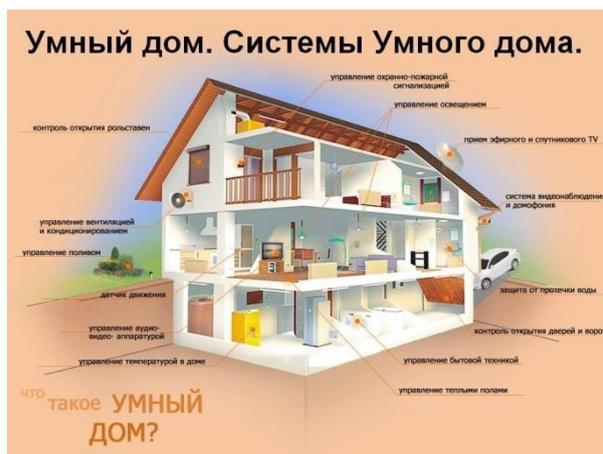
Рис.1. Система умный дом
