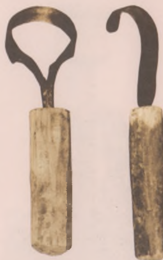
Инструменты для резьбы по дереву: круглый скобель ( ямфро иышкы ) и резец ( онгос )
