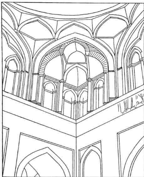
6. Подкупольные конструкции ранних мечетей Ирана: в Казвине, Эрдестане и Гольпайегане
