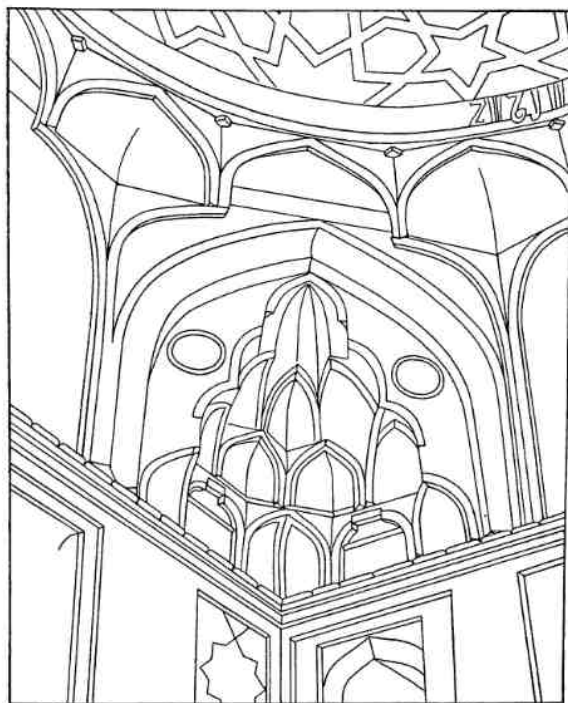
6. Подкупольные конструкции ранних мечетей Ирана: в Казвине, Эрдестане и Гольпайегане
