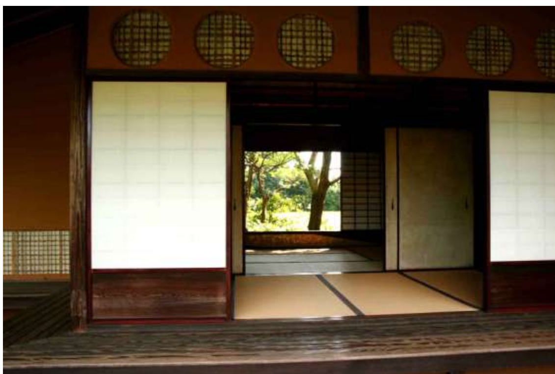
Рис. 95. Киото, вилла Кацура. Вид на интерьеры Нового сёин. Модульная разбивка планов помещений на основе татами; вид через веранду и раздвижные перегородки амадо (внешние перегородки) и фусума (внутренние перегородки–стены) в сад, находящийся по другую сторону дома.
