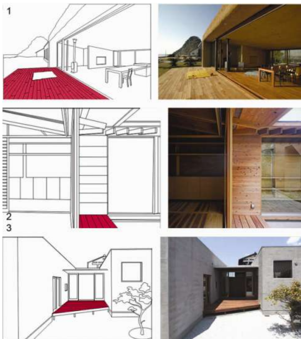
Рис. 115. Веранда энгава традиционно осуществляет связь между домом и окружающим пространством: 1-Чиба, дом «С», арх. Хироши Накамура & NAP; 2-Осака, дом в Вакаура, Archivi Architects & Associates; 3-Фукуока, дом со стеной, арх. Масао Яхадзи.
