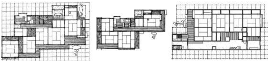
Рис. 96. Композиция планов матии, основанная на кен-модульной системе. Слева – направо: ступенчатая, групповая, линейная.
