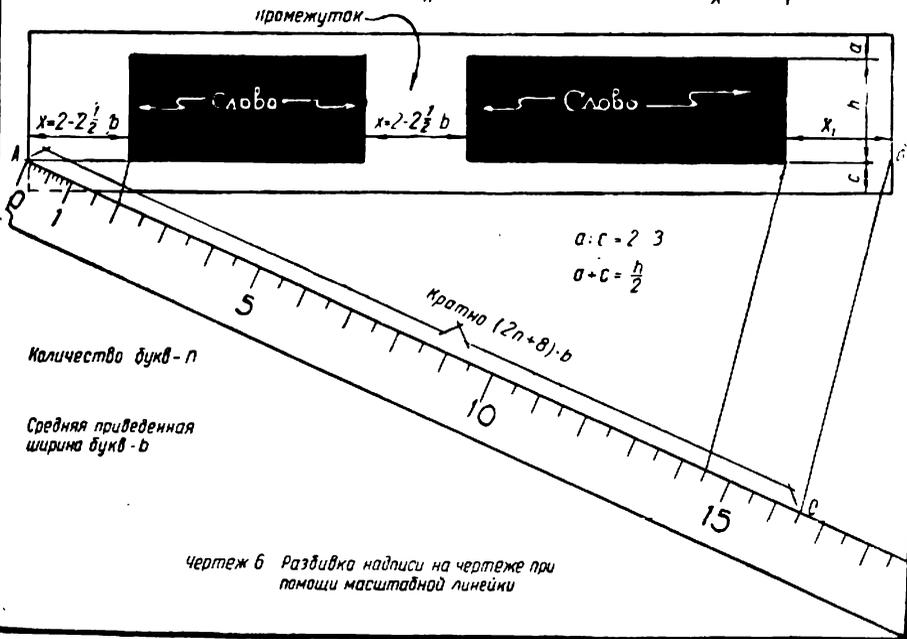
Чертеж 6. Разбивка надписи на чертеже при помощи масштабной линейки
