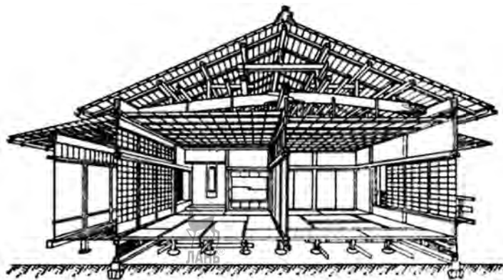
Рис. 40.1 Традиционный японский дом — минка. Разрез
