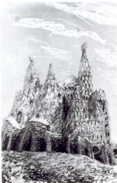
Фото стереометрической модели церкви, ретушированная Гауди с целью отработки пластической формы здания
