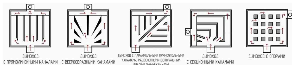
Рис. 93. Типы дымоходов отопительной системы ондолъ
