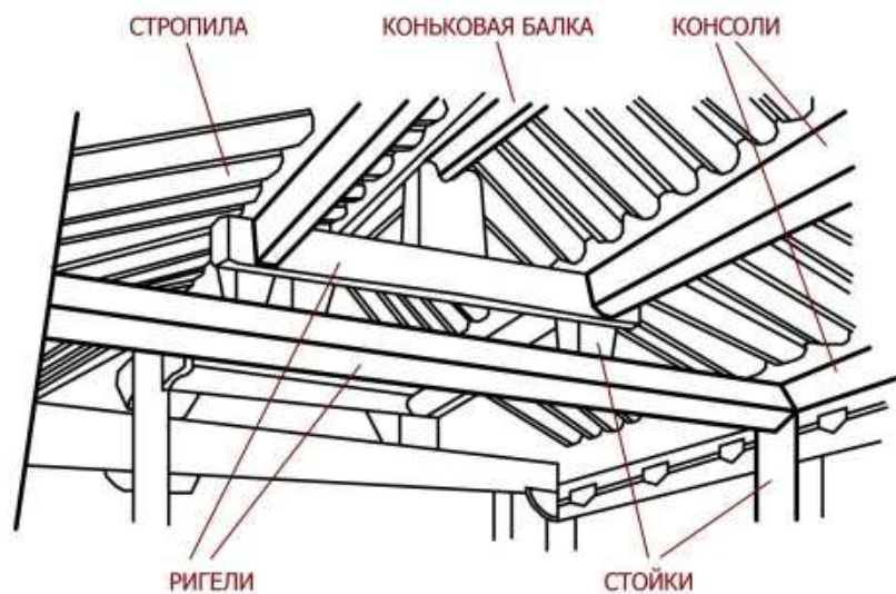
Рис. 91. Схема конструктивного устройства крыши
