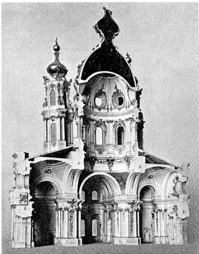
Б. Растрелли. Макет разреза собора Смольного монастыря. (1748-1764 гг.)
